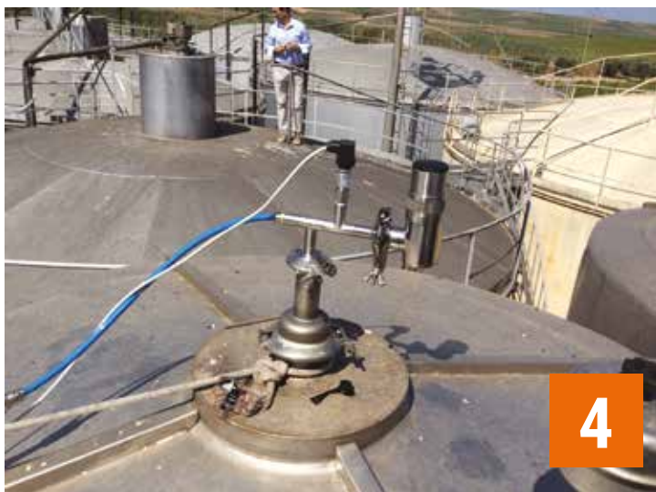
3 - Bioreattori per la coltivazione delle alghe che utilizzano la CO_2 di fermentazione 4 - Vasche in fermentazione collegate con sensori per monitorare la pressione
