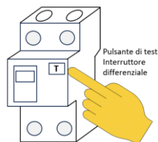
Fig. 7.3.1 – prova differenziali con pulsante di test
