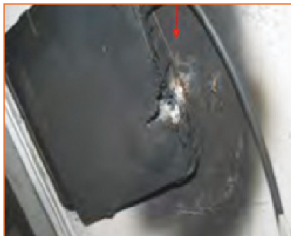
Fig. 6 - Incendio con origine nelle scatole di giunzione dei moduli.
