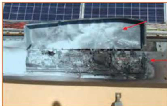
Fig. 10 - Quadro di stringa chiuso in una scatola metallica installata su una gronda in lamierino.
