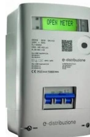
Tramite il protocollo CHAIN 2 integriamo le letture direttamente dal gruppo di misura senza l'inserimento di misuratori di energia di terza parte
